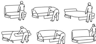
Механизм серии АККОРДЕОН может быть двухспальным и односпальным. Основания снабжены латами и накладными латодержателями, в обновлённой модификации каркаса латы сиденья заменены металлической сеткой. Он состоит из трех частей, связанных между собой шарнирными соединениями, и раскладывается вперед, по принципу гармошки. Высокое, широкое и ровное спальное место, подходит для сна и отдыха в положении лежа.
