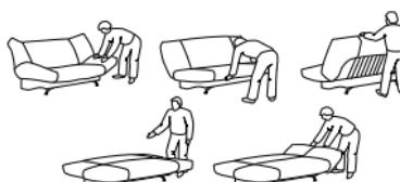
Механизм состоит из двух оснований, связанных между собой трехпозиционными замками. Основания снабжены латами и накладными латодержателями. Трансформация мебели с механизмом КНИЖКА-ТРАНСФОРМЕР производится аналогично трансформации обычного КЛИК-КЛЯКА.
